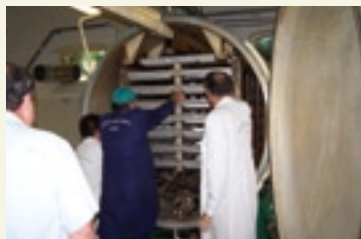
54. Elázott, gyorsfagyasztott újságkötetek behelyezése a fagyasztva szárító berendezésbe
