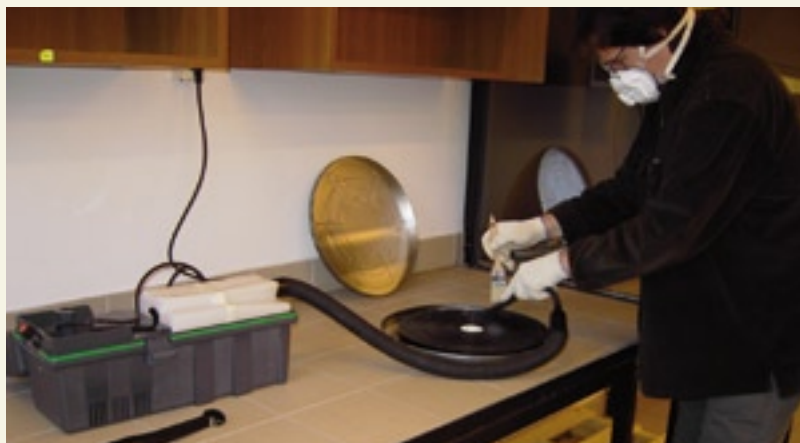
30. Mozgófilmtekercs megtisztítása a penészmaradványoktól ecsettel és porszívóval, egyéni védőfelszerelés használata mellett
